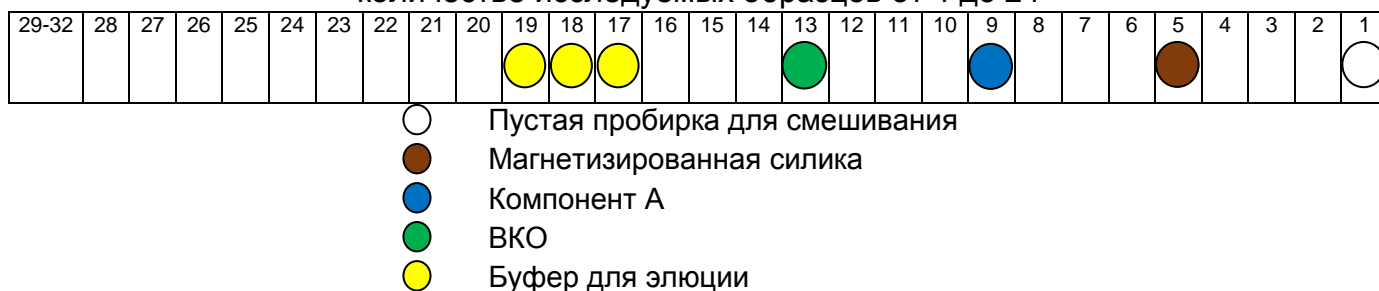
Рисунок 4 – Пример заполнения штатива для реагентов в пробирках при общем количестве исследуемых образцов от 4 до 24
