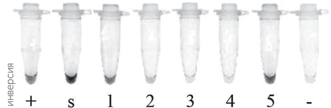
Рис. 2 – Детекция остаточной РНКазной активности смывов с поверхности, загрязненной РНКазой (источник – слюна). Набор RNaseAlert, экспозиция реагента-детектора – 24 часа. Обозначения образцов:
